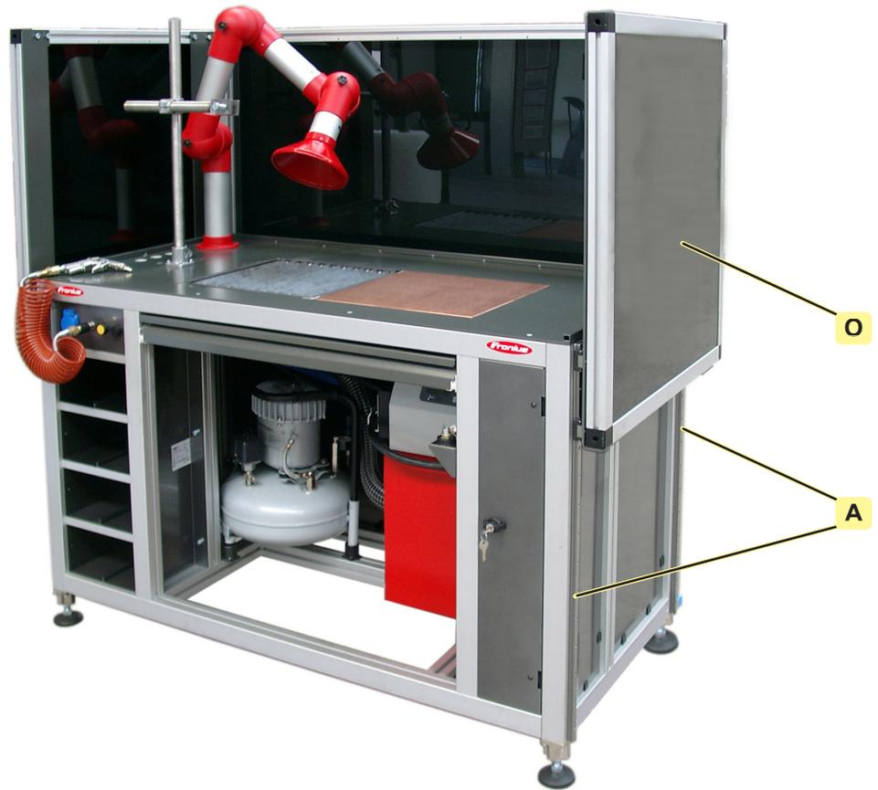
Justieren der Geschwindigkeit der Schutzgläser durch Verstellen der Abluft-Drossel mittels Winkel-Schraubendreher möglich
